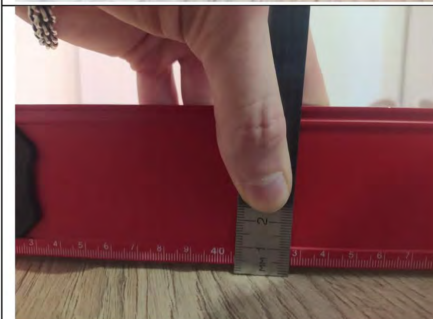
Фото №14. Измерения уровня напольного покрытия в спальне.
